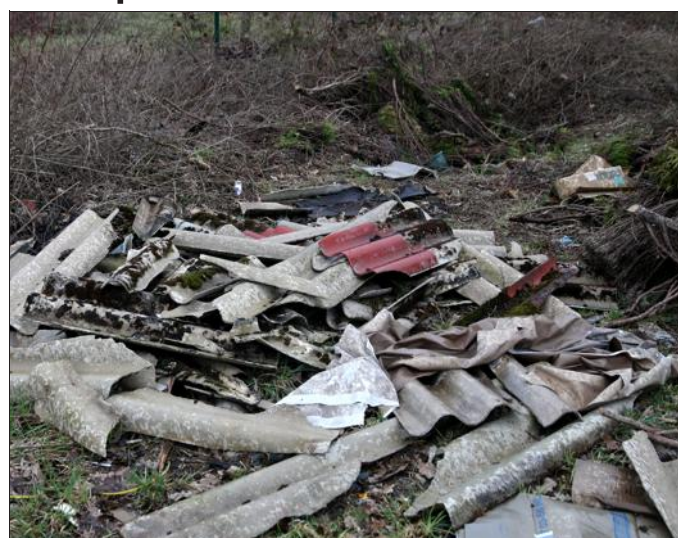
Les plaques de fibrociment chargées en amiante nécessitent l'intervention d'une entreprise spécialisée. Photo RL/Pierre HECKLER
